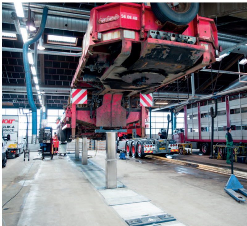
Stiholt/Scania i Thisted bruger deres 5-søjlede lift som to uafhængige lifte, når der er spidsbelastning på værkstedet
