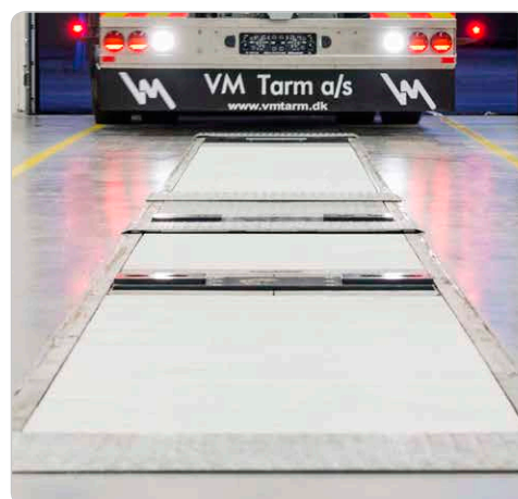
Rammeløsning Ramme leveres separat, løftesøjler og styring eftermonteres
